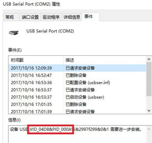
上图红色方框内显示的是本产品的 VID、PID 的参数，如果同一台电脑连接多台 USB 转串口的设备可以通过该参数判断端口是否是本产品以便选择正确的 COM 端口。
